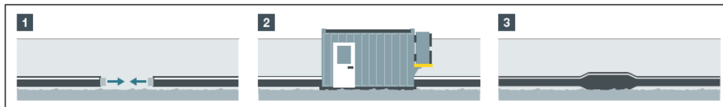
Abbildung 4: Schematische Darstellung der Kabelverbindungen (Muffen) 4
